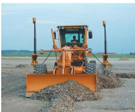
Система 2D System Five компании Торсон является гибким инструментом для выполнения многообразия сложных работ. Основной особенностью System Five является модульность и расширяемость комплекта используемых сенсоров.
